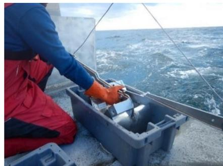
Figure 16: Utilisation de la Benne Van Veen d'IDRA Bio & Littoral : surface d'échantillonnage de 0,1 m<sup>2</sup>
